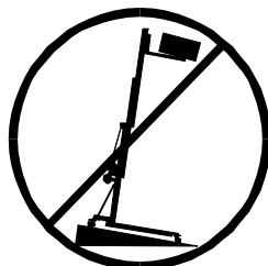
3.2 - Placer le pied sur une surface dure et horizontale.
