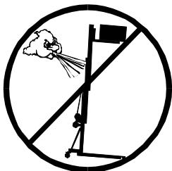
**3.6 -** Bei Freiluftanwendungen den Turm auf festen Boden stellen und mittels Seilanker gegen Windbelastung sichern. Niemals an Fahrzeugen die Abspännungen befestigen oder an Gegenständen, die ausweichen könnten.
