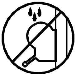
**3.15** - Ölen oder Fetten der Fallbremsen ist zu unterlassen, da diese mit einem Druck und Hitzebeständigen Material bearbeitet wurden. Andere Werkstoffe führen in der Handhabung zu negativen Effekten.
