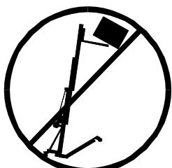
**3.3 -** Vergewissern Sie sich, dass die Ausleger richtig eingesteckt sind und nutzen Sie die Rastbolzen zum feststellen!
