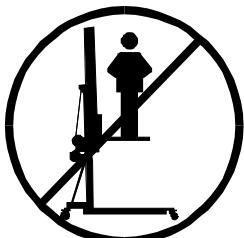
**3.1** - El elevador TL-072 es una máquina diseñada para la elevación de cargas en sentido vertical, NUNCA se debe utilizar como plataforma elevadora de personas.
