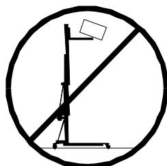
3.4 - Ne pas éléver si la charge n'est pas correctement centrée sur l'attachement de manutention de charge.
