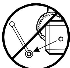
**3.13** - Il est interdit de démonter la manivelle du treuil (**W**) lorsque celui-ci est en tension.
