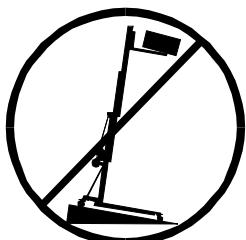
**3.2 -** Achten Sie darauf, dass der TL – Tower auf festem, geraden Untergrund steht. Und vergewissern Sie sich mit Hilfe der Wasserwaage (F), dass er eine vertikale Position zum Boden eingenommen hat. Bei Bedarf mittels des Stellstellers (Q) durch Drehen der Spindelkurbel (H) die entsprechende Tunlage einstellen.
