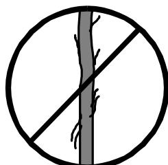
**3.12** - Antes de utilizar el elevador, verifique el estado del cable. El cable no debe presentar rotura de hilos o aplastamiento. NUNCA use cables defectuosos y en caso de duda cambie el cable. Sólo utilice cable de acero según DIN 3060. Calidad 180 Kg/mm<sup>2</sup> resistente a la torsión.
