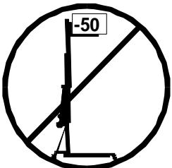
**3.14** - Die maximale Belastung zur Überprüfung der Sicherungen ist 50 kg. Ohne Belastung ist die Überprüfung nicht möglich.
