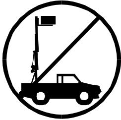
**3.11 -** Es ist nicht gestattet den Lift auf einem Fahrzeug mit einem mobilen Unterbau zu installieren!
