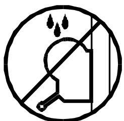
**3.15** - Ne pas mettre d'huile ou graisse sur le mécanisme du frein. Les rondelles du mécanisme de frein ont été lubrifiées en usine avec une graisse spéciale. L'utilisation d'une autre graisse altérerait grandement l'efficacité du freinage. Il n'est pas nécessaire de graisser ce mécanisme.
