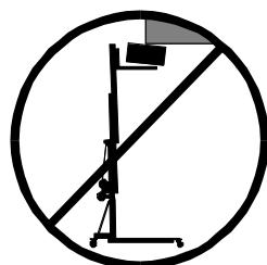
**3.8 - Veiller à ne pas accrocher des câbles et autres objets placés au dessus du elevateur.**
