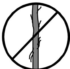
**3.12** - Avant toute utilisation, vérifier le bon état du câble, Vérifier régulièrement le câble ( boucles, plis, rupture de brin, usure anormale ). Un câble abîmé doit être remplacé immédiatement. Ne jamais utiliser le pied avec un câble défectueux. Utiliser exclusivement un câble répondant à la norme DIN 3060.
