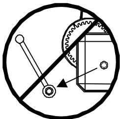
**3.13** - Niemals die Winde, oder Teile der Winde unter Belastung demontieren.
