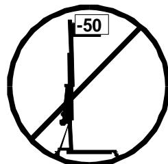
**3.14** - La carga mínima para un funcionamiento del freno sin problemas es de 50Kg. Sin esta carga mínima el freno no actuará.
